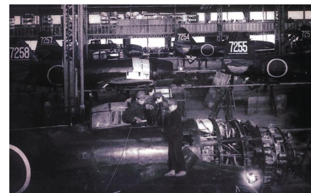
生産中の局地戦闘機『紫電』一一型（乙型）
