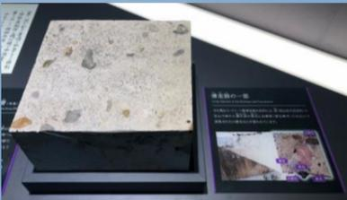
◀ 今も残るコンクリート製滑走路の材料には、長（現加西市西長町）の石山で採れた凝灰岩の長石と加東郡（現加東市）の加古川で採取された川原石などが使われています。
